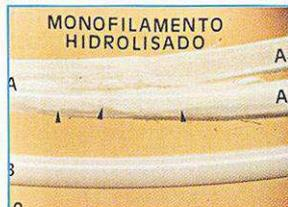
Um monofilamento de poliéster, após ter sido submetido a 336h a 121°C - vapor saturado. A parte A mostra com fissuras longitudinais (setas) e rachada (A1 e A2) após ter sofrido um esforço mecânico (esmagamento) pela barra do dinamômetro. A parte B, embora hidrolisada, parece estar fisicamente perfeita, retendo apenas 47% da sua resistência à tração original.
