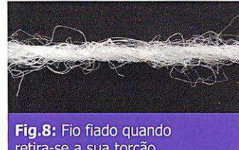
**Fig.8:** Fio fiado quando retira-se a sua torção.
