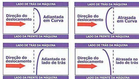
As principais causas de distorção de vestimentas são provocadas pelos efeitos da distância e da velocidade. Geralmente o posicionamento da linha guia, ou da emenda, é o resultado da combinação dos dois efeitos.
