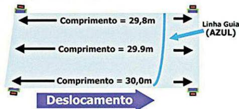
A figura acima ilustra uma situação de máquina que favorece a distorção da Linha Guia pelo fato do caminho a ser percorrido pela vestimenta ao redor da máquina (comprimento) ser menor em uma das laterais. Esta situação pode ocorrer em função de rolos desalinhados.
