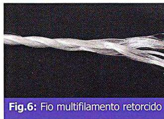
**Fig.6:** Fio multifilamento retorcido
