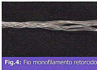
**Fig.4:** Fio monofilamento retorcido
